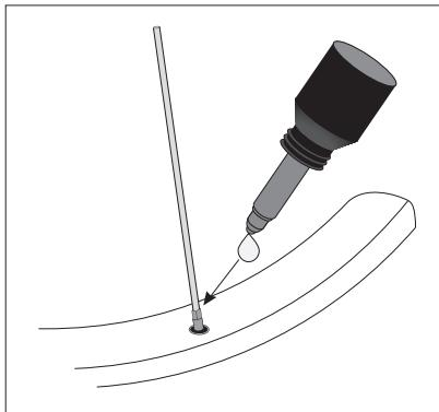
La résistance définitive maximale est atteinte après 12 heures (à une température ambiante), mais la roue peut déjà être utilisée après quatre heures. Le collage reste permanente à des températures ambiantes entre -50°C et +150°C.
