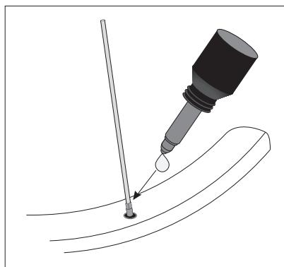
Die maximale Endfestigkeit wird (bei Raumtemperatur) nach 12 Stunden erreicht; das Laufrad kann jedoch schon nach vier Stunden gefahren werden. Die Klebung bleibt bei Raumtemperaturen von -50°C bis +150°C stabil.
